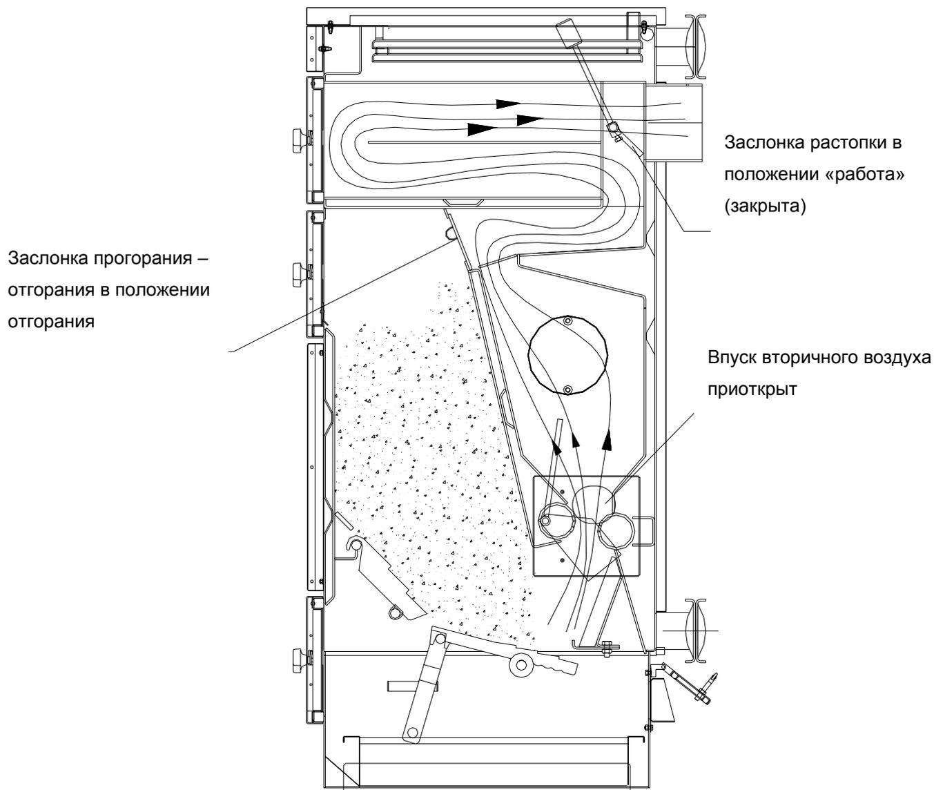
Сжигание топлива в режиме отгорания применяется для:
