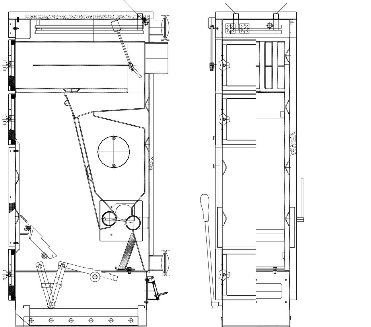
**Рис. 3 Вид котла в разрезе**
